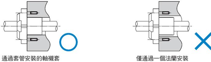
通過套管安裝的軸襯套
