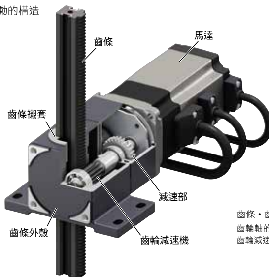
齒條垂直移動的構造
