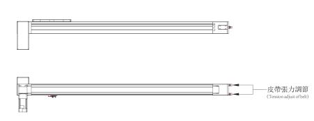
注:底部安裝位置可選裝在68的位置要求打M6固定牙孔。
