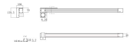
注:底部安裝位置可選裝在46的位置要求打M5固定牙孔.
