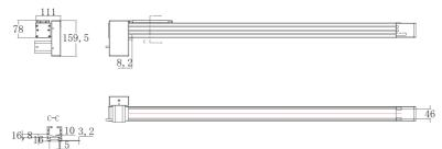
注:底部安裝位置可選裝在46的位置要求打M5固定牙孔。
