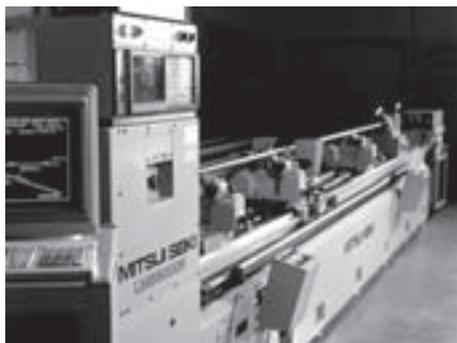
鐳射自動導程測試儀
