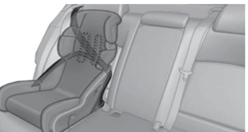
Có thể khóa các dây đai an toàn ghế sau lại để ghế khỏi bị kéo ra khi lắp hệ thống ghế an toàn dành cho trẻ nhỏ.
