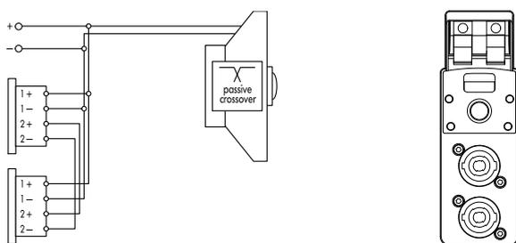
Fig. 2: Connector wiring
