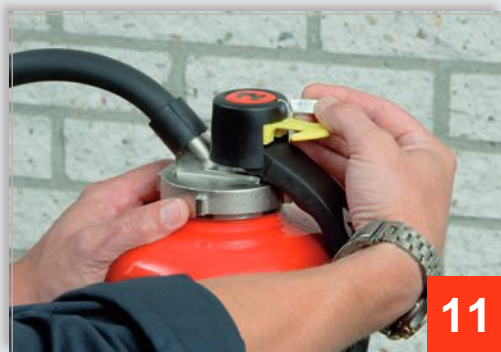
Blustoestel wordt verzegeld met indicator en zegel
