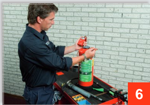
Controleren van de coating van het schuimblustoestel middels doormeten
