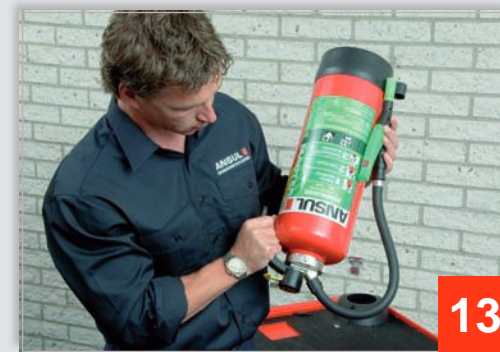
Blustoestel controleren op lekkage
