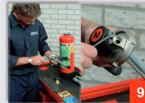
Vervangen van O-ring en afdichtingen
