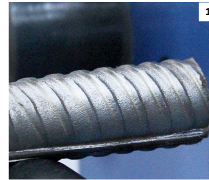
1 Barre non filetée L'extrémité (à fileter) est coupée à angle droit (90°).
