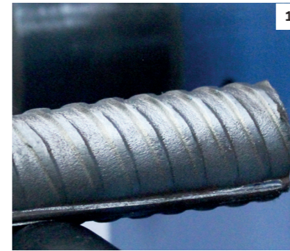
1 Stange ohne Gewinde Das eine Endstück (Gewindezone) wird gerade (90°) geschnitten.
