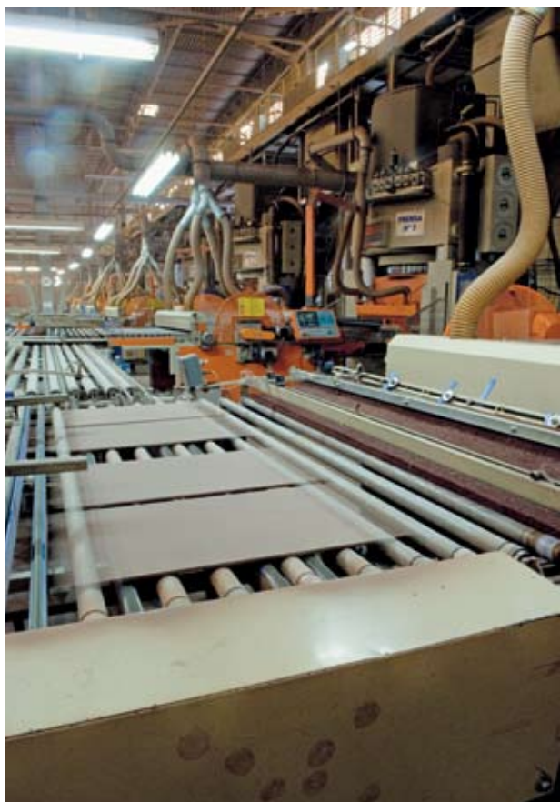
Processo de produção cerâmica automatizado: etapas de prensagem e esmaltação de peças
