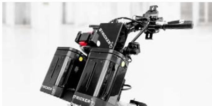
**Lipo Lomo - deux supports de batterie sur le tube du palier de direction**
