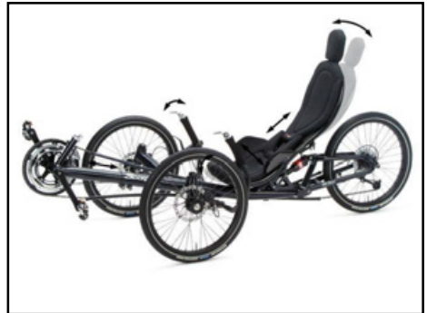
Possibilités de réglage sur les tricycles avec sièges BodyLink
