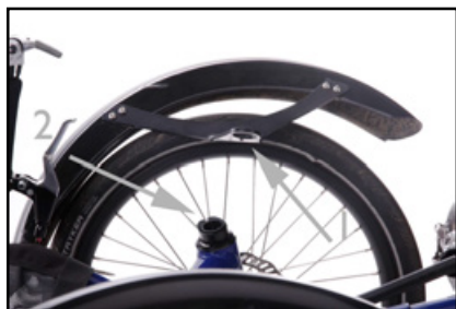
Vis sans tête (1) et fente de serrage (2) pour le montage du garde-boue
