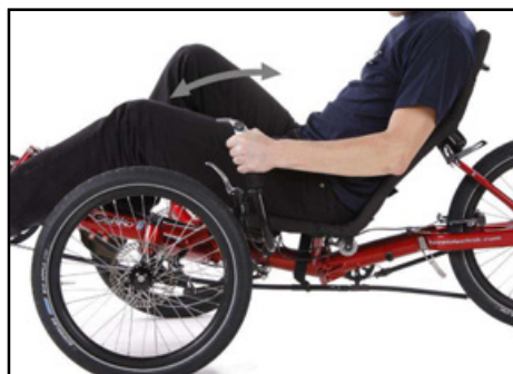
L'inclinaison du guidon est réglable
