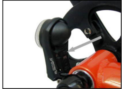
L'éclairage alimenté par une dynamo de moyeu et des VAE sont équipés d'un interrupteur sur le feu.
