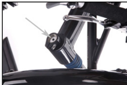
Vis de réglage de la précontrainte du ressort du combiné-amortisseur, à l'intérieur du porte-moyeu
