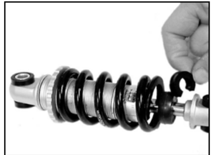
L'ajout de clips d'épaisseur à la tige du piston de l'amortisseur en limite la course.
