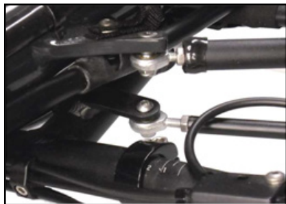
Extrémité intérieure de la barre d'accouplement
