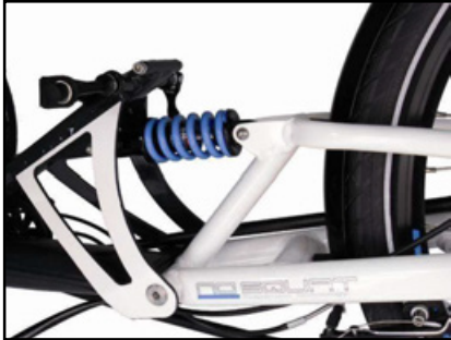
Combiné-amortisseur à ressort en acier La précontrainte du ressort se règle en tournant la molette de réglage à l'extrémité avant du ressort.
