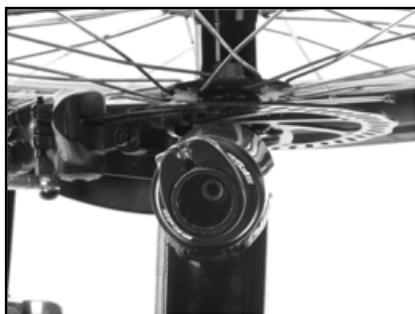
Roulement de tube de direction ouvert avec insert à griffe à l'intérieur.
