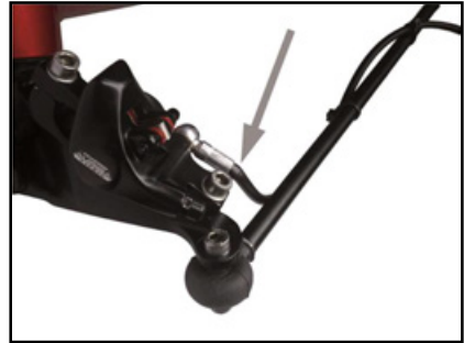
MAUVAIS : la durite fait un coude brusque pour passer devant la barre d'accouplement, elle risque de casser au niveau de la flèche.
