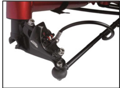
BON : bonne disposition de la durite du frein gauche
