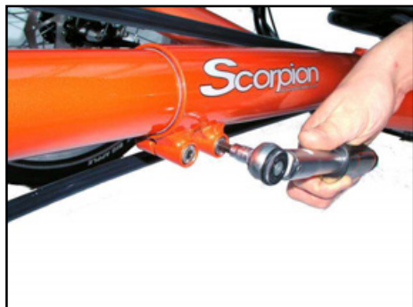
Desserrage des vis de blocage du bôme
