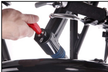
Dévisser la bride pour pouvoir tourner la vis de réglage de la jambe de suspension.
