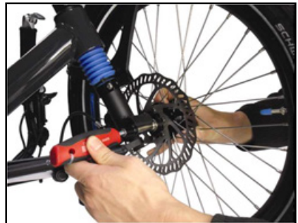
Dépose de la roue avant : dévisser de la vis de la douille d'extrémité d'axe
