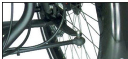
Extrémité extérieure de la barre d'accouplement
