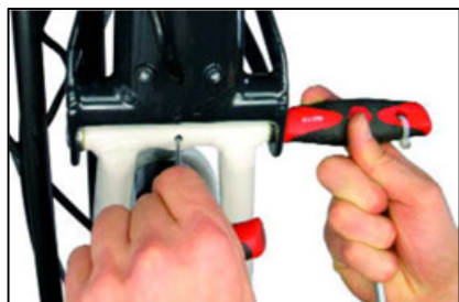
Un trou se trouve sur la face inférieure du bras oscillant de la roue arrière. Il est possible de bloquer l'axe en rotation à l'aide d'un tournevis fin ou d'une tige métallique.
