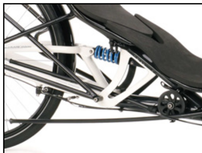
Poulie de renvoi, guide-chaîne et gâines de chaîne du Scorpion fs 26
