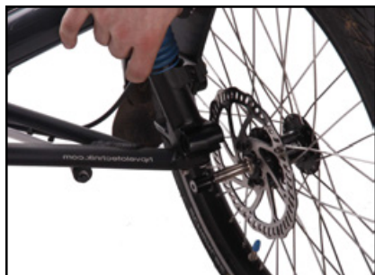
Dépose de la roue avant : retirer l'axe du porte-moyeu
