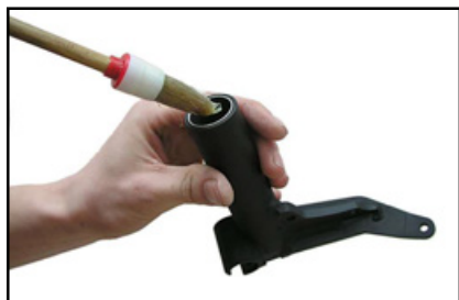
Graissage des douilles de guidage
