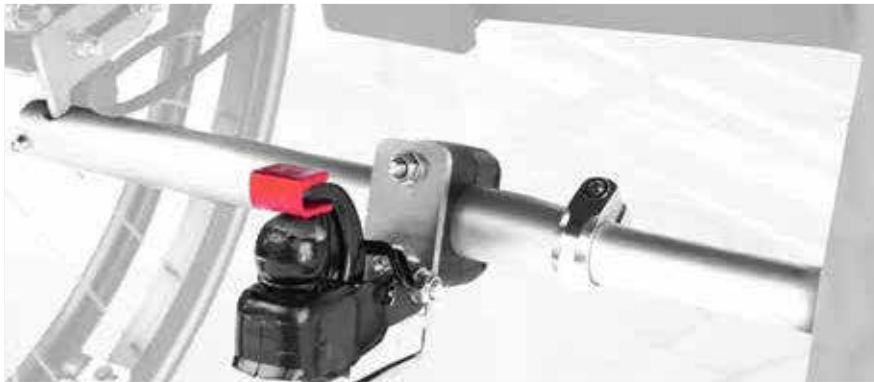
Anhängerkupplung mit Querrohr für Faltrollstühle
