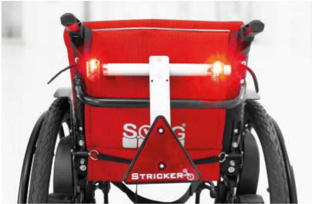
Barre de feu arrière avec feu arrière à batterie et triangle de signalisation
