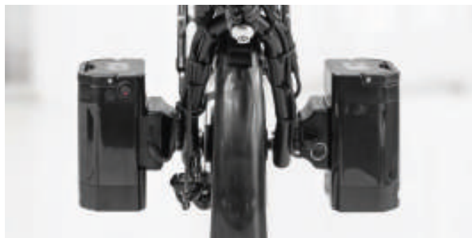
Lipo Lomo - deux supports de batterie sur la fourche
