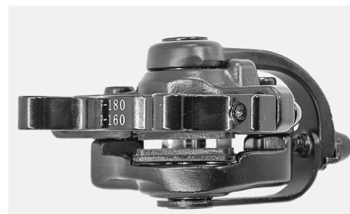
Étriers de frein à disque à mouvement synchrone
