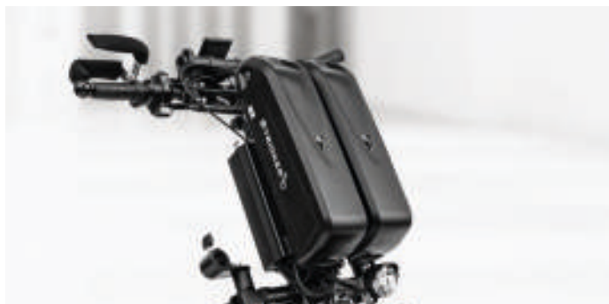
Handbikes Tout Électrique 48 V - deux supports de batterie sur le tube du palier de direction
