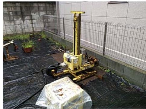
3.3cmのスクリーロッドに重さと回転で地中に貫入させて抵抗力を調べる地盤調査
