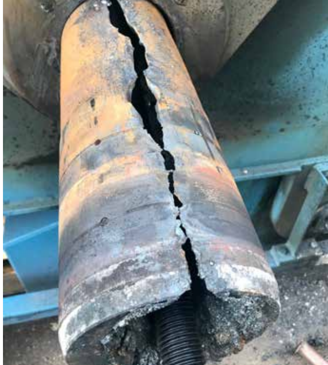
Na het vakkundig doorvloeien van de as, zonder het omliggende materiaal te beschadigen, kan de as gekoeld worden en zonder problemen getrokken. (Beeld: Duikbedrijf COW)
