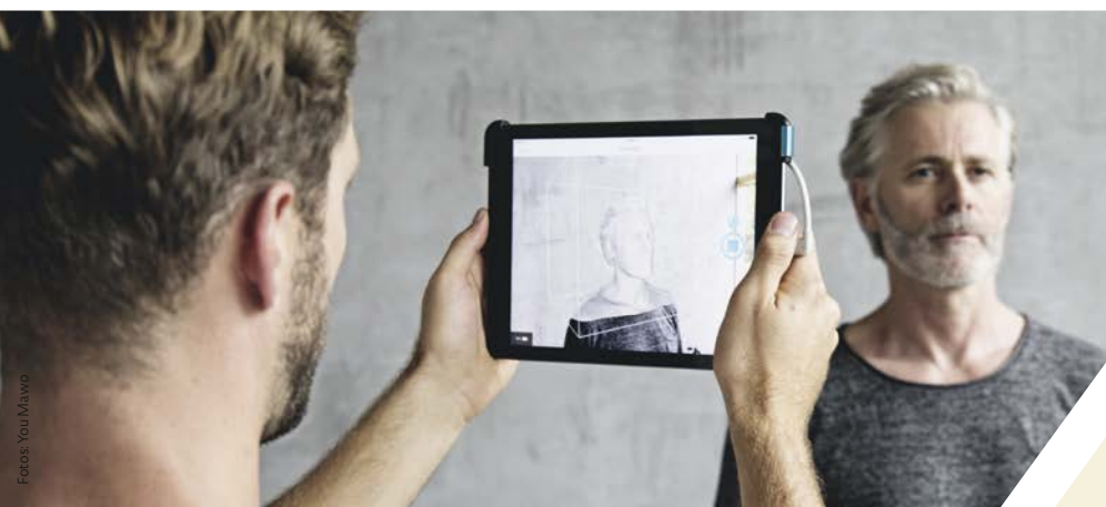
Der Scan beim Optiker: Über das iPad gesteuert, erfasst die von You Mawo entwickelte 3D-Infrarot-Scanner-App Gesichtsstrukturen innerhalb von 30 Sekunden
