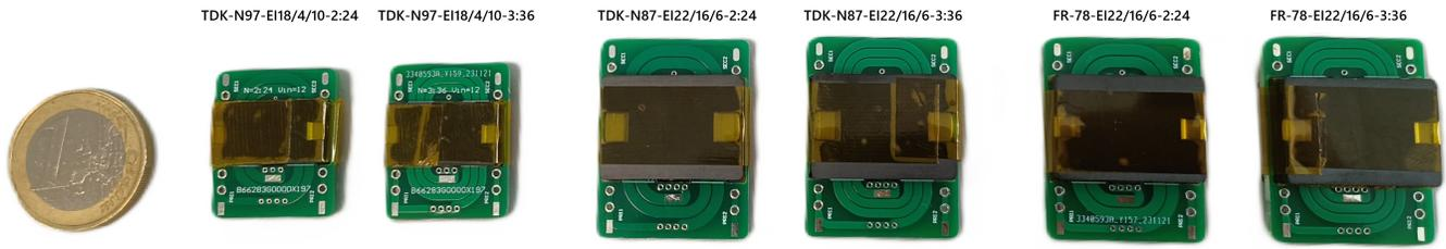
Figura 3: Transformadores planos diseñados. Moneda como escala.
