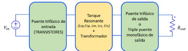
Figura 1. Esquema de un convertidor resonante de tres fases
