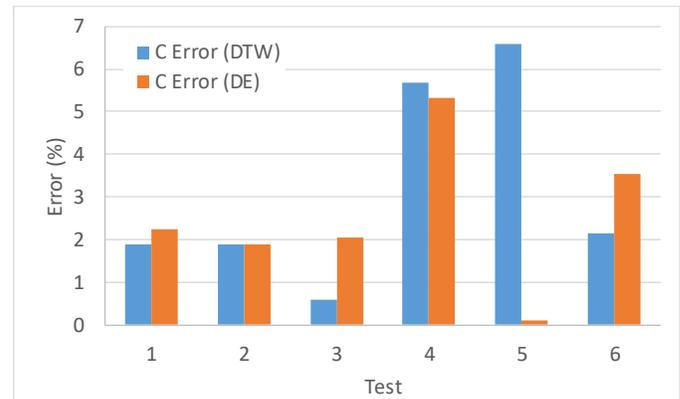
Figura 8 Comparación de los resultados del cálculo de la capacidad del condensador de salida obtenido con la distancia Euclídea (DE) y el obtenido con el Dynamic Time Warping (DTW).
