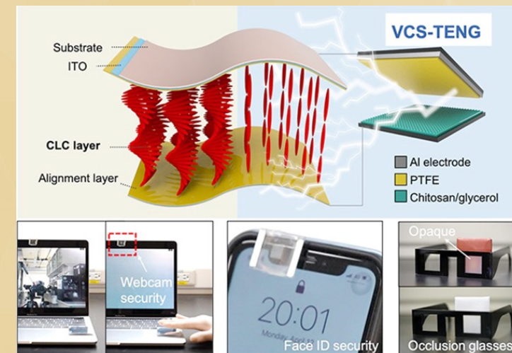
奈米自供電液晶元件設計結構與其相關應用圖 (ACS Energy Letters 6.9 (2021): 3185-3194.)
