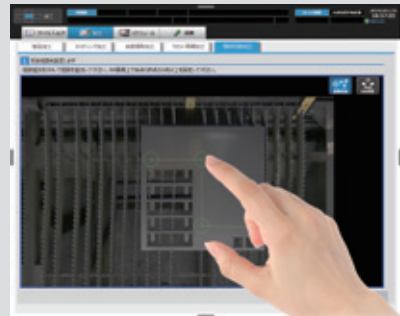
可將程序形狀重疊在轉換後圖像上，直觀地進行定位操作以及在餘料上配置要加工的產品。
