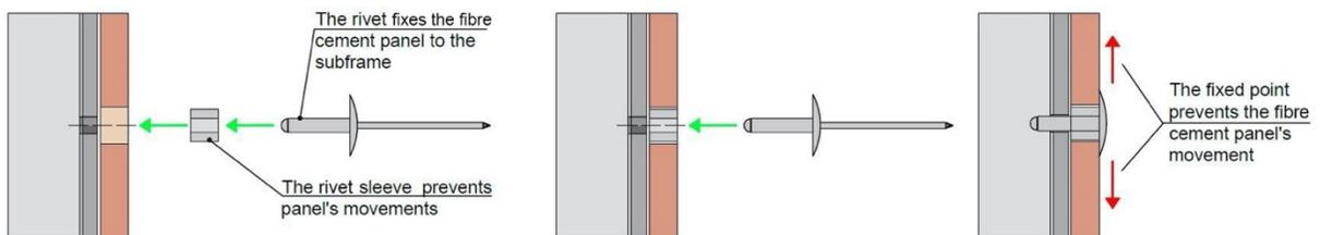
**FIXING: SLIDING POINT USING ONLY THE RIVET**
