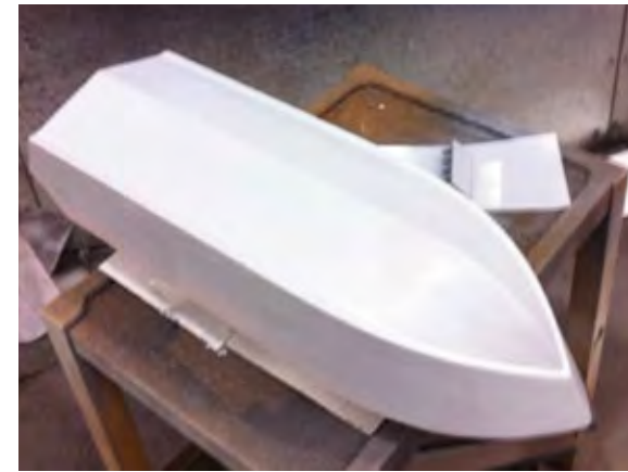
-Filler primer applied the hull
