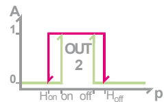
The outputs 1 and 2 are separately programmable/ Die Ausgänge Out 1 und Out 2 sind separat programmierbar
