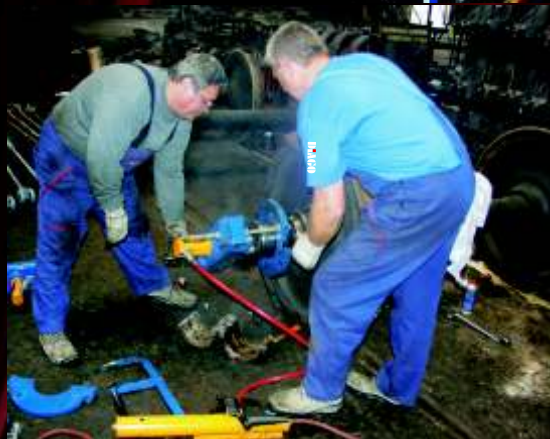
sťahovanie vnútorných krúžkov vagonových ložísk a labyrintov
