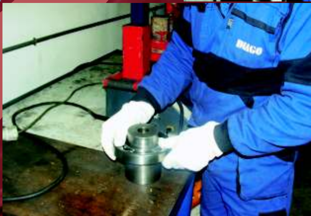
- montáž ložísk pomocou indukčného ohrievača
