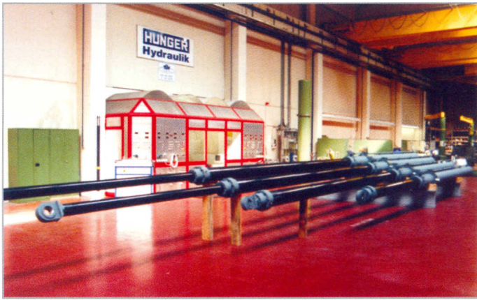
Teleskopzylinder für Radialschützbetätigung, Cachi Damm, Costa Rica
