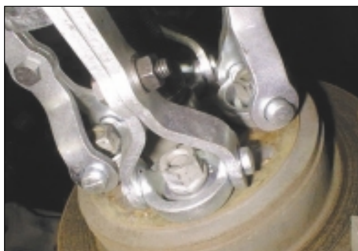
a) hydraulické vreteno b) disk so zárezmi c) sťahovacie rameno
