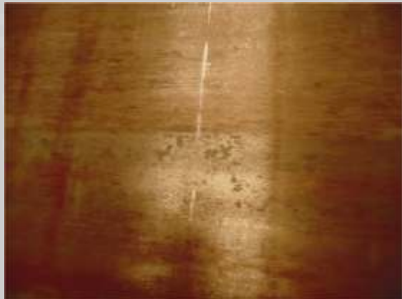
Problém kvality povrchu - bez aplikácie antioxidantu
