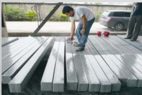
Nastriekavanie antioxidantu na hranolové ingoty
