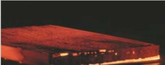
Brama bez použitia antioxidantu po odokujení Brama without antioxidant after descaling
