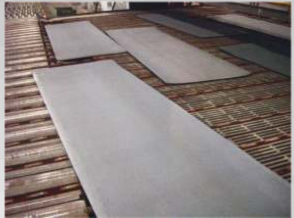
Brama po valcovaní s použitým antioxidantom Brama after rolling with the use of antioxidants
