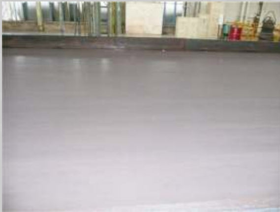
Pásová oceľ po valcovaní s použitým antioxidantom Strips after rolling with the use of antioxidants
