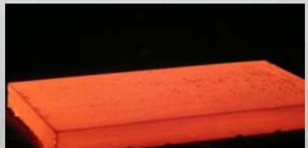
Brama po odokujení ( bez použitia antioxidantu )
