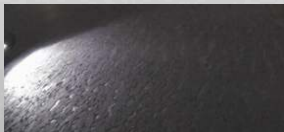
Povrch bramy po valcovaní bez aplikácie antioxidantu
