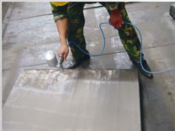
Nastriekavanie na povrch bramu
