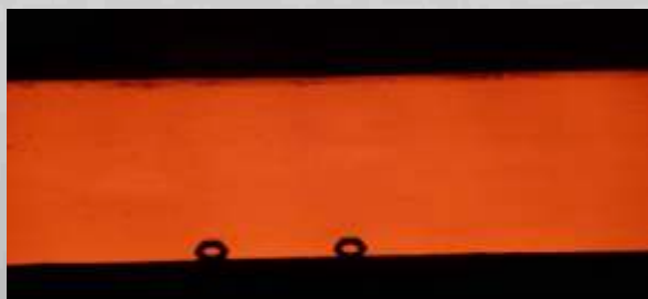
Valcovanie po aplikovaní antioxidantu na celý povrch
