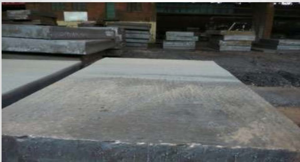
Polovica povrchu s použitím antioxidantu, druhá polovica bez jeho použitia Half of the surface using an antioxidant, the second half without its use
