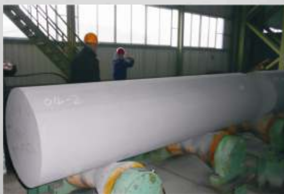
Nastriekavanie antioxidantu na valcovité ingoty s veľkým priemerom
