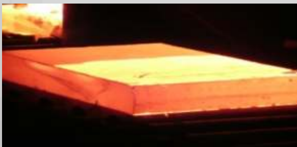
Brama po odokujení ( na polovici použitý antioxidant )
