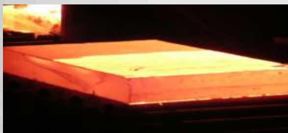
Brama po odokovinovaní ( na polovici použitý antioxidant )
