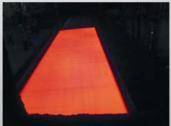
Brama zo špeciálnej ocele, na ktorej bol antioxidant po ostriekaní prúdom vody
