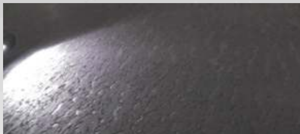
Povrch po valcovaní bez antioxidantu Surface after rolling without antioxidant
