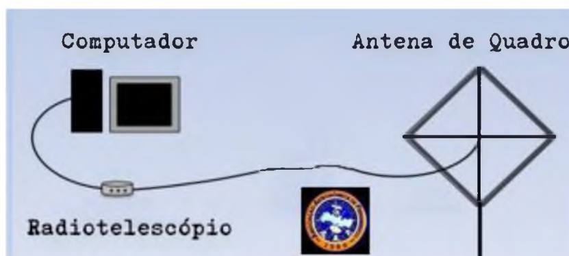
Figura 11 - Esquema simplificado do sistema de radiotelescópio da A.A.P., em funcionamento
