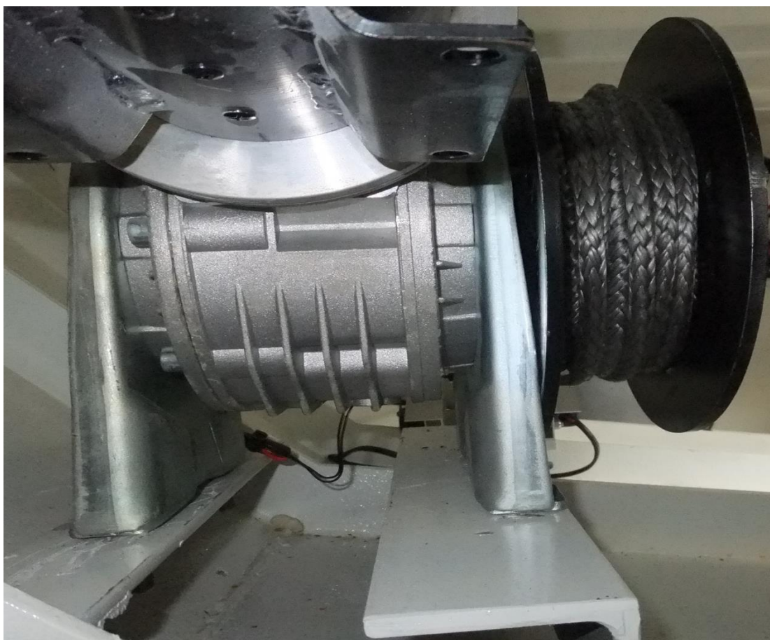
Omgebouwde ankerlier met kabeltrommel.
