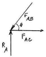
$$F_{AB} \sin \theta - R_A = 0; F_{AB} = \frac{1}{\sin \theta} R_A = \frac{5}{4} \frac{1}{3} W \quad F_{AB} = \frac{5}{12} W \text{ compressão}$$
