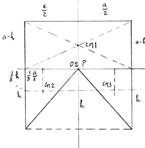
Para que o equilíbrio seja indiferente é preciso que  $Y_{CM_t}$ , centro de massa total, coincida com o vértice  $P$  do corte e, para o sistema de eixos da figura, com a origem das coordenadas.
