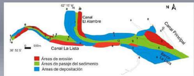
Figura 5. Localización de las áreas con dominio de procesos erosivos, de transporte y de depositación en el Canal La Lista.
