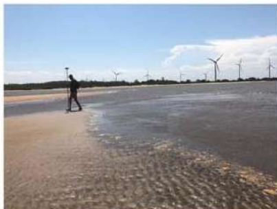
Figura 2. Caminhamento com DGPS GTR-G2 (TechGeo) em Gargaú.
