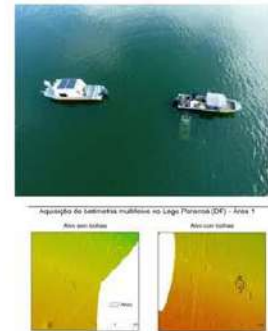
Figura 2. Esquema do experimento controlado de injeção de gás (ar comprimido) no fundo (lodoso) do Lago Paranoá (DF), empregando uma embarcação para injetar o gás numa estrutura acrílica com base metálica (alvo submerso), e outra para o registro de dados de Ecobatímetro Multifeixe de 420 kHz. A assinatura acústica do fundo difere no caso do alvo com e sem bolhas, mostrando a influência da presença do gás na resposta acústica
