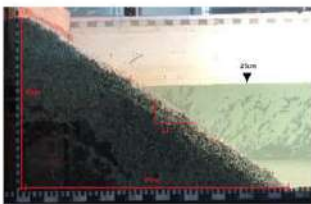
Fig.2: Foi criado um perfil de praia artificial composto inteiramente de conchas na extremidade mais afastada do batador, onde manteve-se a mesma declividade inicial e o nível d'água no tanque para todos os experimentos.
