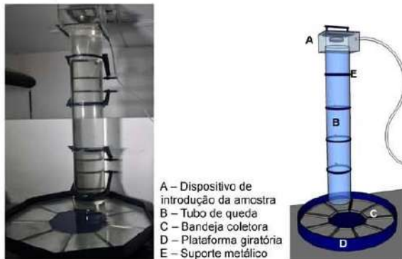
Figura 2. Tubo de queda.
