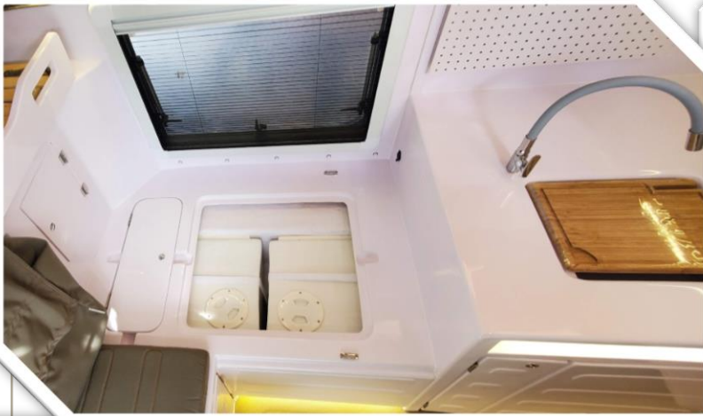
Die 2 Wassertanks mit den Wartungsluken
