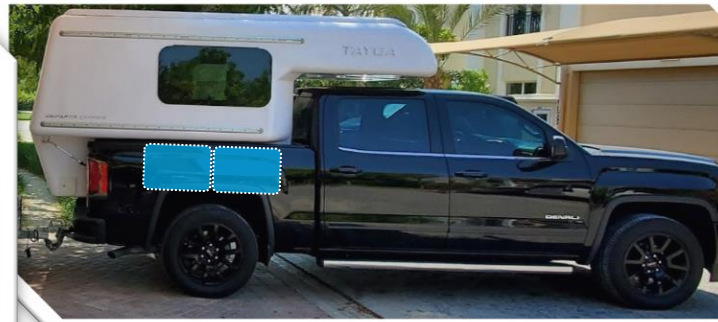
Die Wassertanks an der optimalen Position direkt über der Hinterachse
