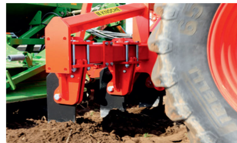
Die Zinken der Tiefenlockerer bearbeiten auch festen Ackerboden tiefgründig.
