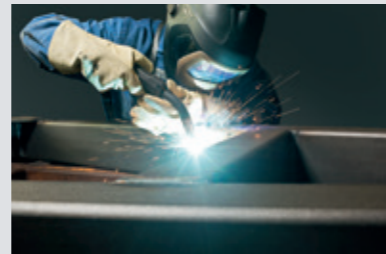
Fertigung der Rahmen nach DIN EN ISO 9606-1 zertifiziertes Schweißen
