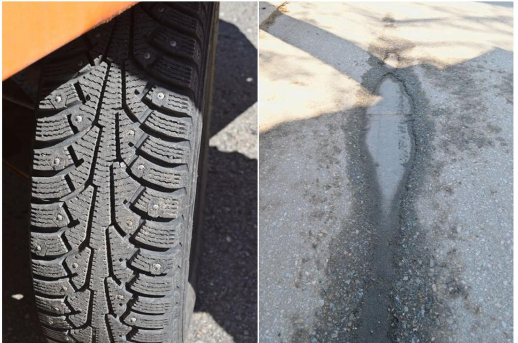
Durch Spikereifen wird der Strassenbelag stark abgetragen.
